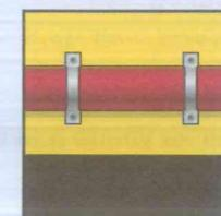
Шланг не должен быть пережат или растянут и должен быть зафиксирован с помощью зажимов безопасности
